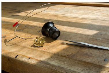
Atelier de fabrication : ébauche, brucelles et loupe d'horloger (dite "microscope" ou "micro"). Phot. Sonia Dourlot IVR43_20152500746NUC2A
