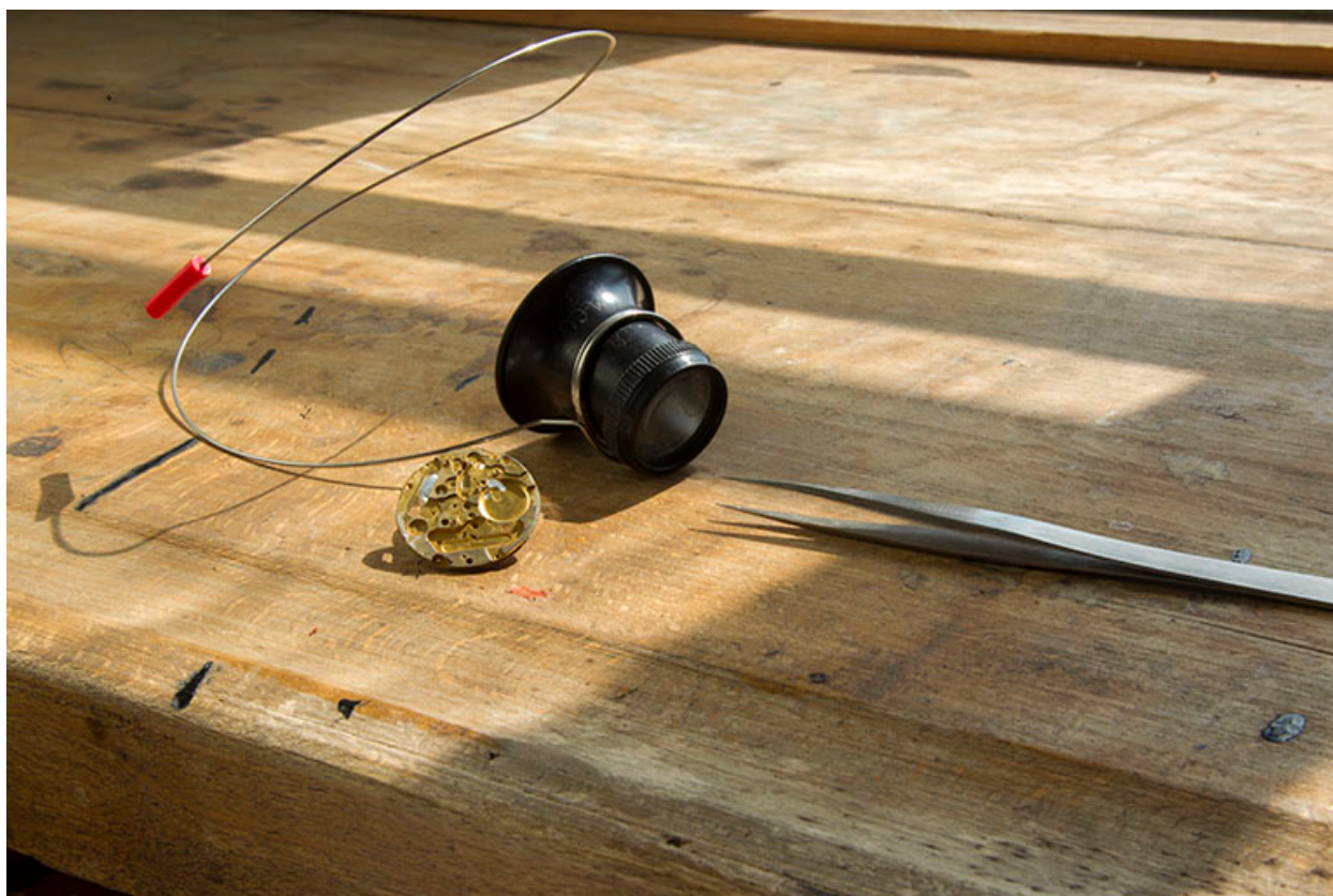
Atelier de fabrication : ébauche, brucelles et loupe d'horloger (dite "microscope" ou "micros").
