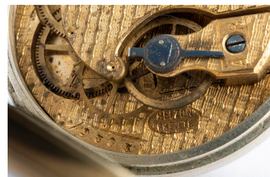
Détail du mouvement : roue en auge de cochon et inscriptions. Phot. Sonia Dourlot IVR43_20182501634NUC4A
