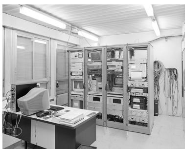
Equipement permettant la comparaison des horloges atomiques et la participation au Temps atomique international. Phot. Jérôme Mongreville IVR43_20032500693V
