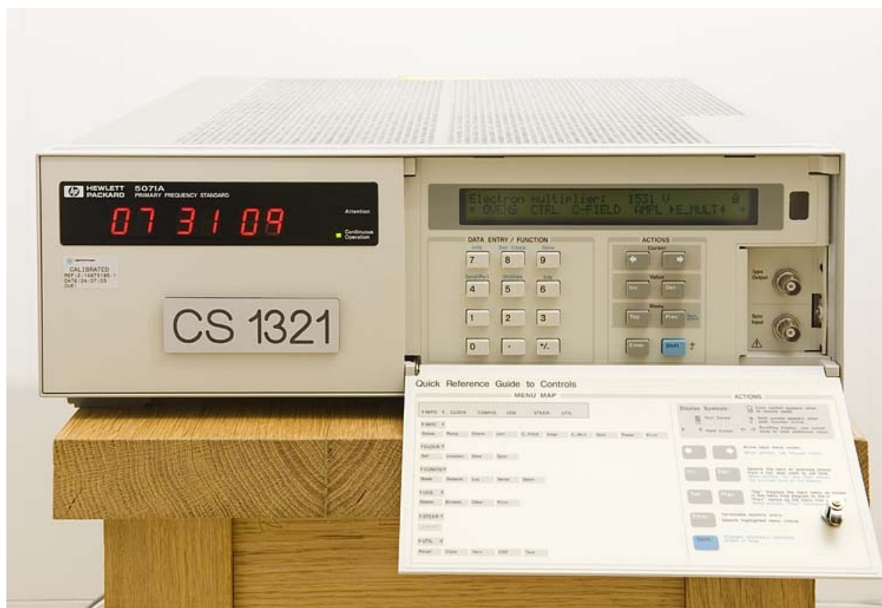
Horloge atomique Hewlett-Packard 5071A : face avant.
