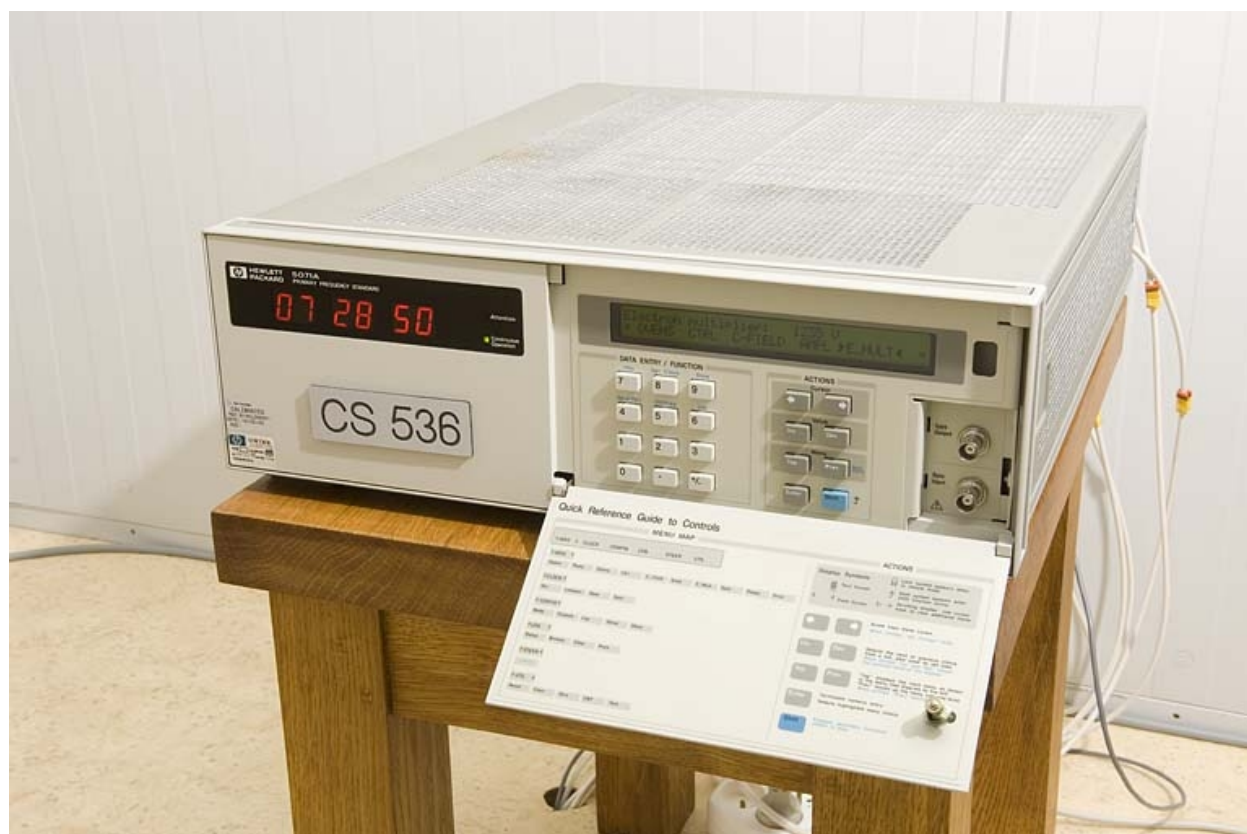
Horloge atomique Hewlett-Packard 5071A : vue d'ensemble.
