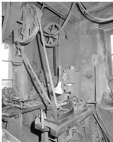
Machine servant à affûter les outils de tourneur. Phot. Jérôme Mongreville IVR43_19963901077X
