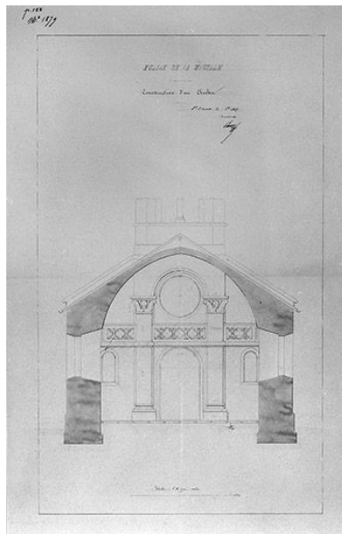
Construction d'un clocher : coupe transversale, 1849. Phot. Jérôme Mongreville, Phot. Auguste Comoy IVR43_20013900325V
