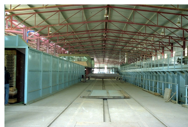
Briqueterie et tuilerie Emile Jacob, Commenailles : tunnel séchoir à gauche et four à bassin à droite. Phot. Laurent Poupard IVR43_19893900056ZA
