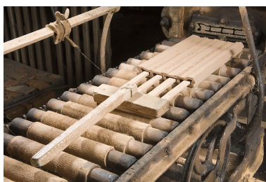
Tuilerie et briqueterie Janicot, Montureux-et-Prantigny. Chariot de découpe de la mouleuse-étireuse Brandt : enlèvement d'une brique creuse (la filière est visible en haut à droite). Phot. Jérôme Mongreville IVR43_20087000784NUC2A
