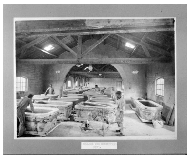
Usine de grès et de porcelaine des Ets Jacob-Delafor et Cie, Damparis : le moulage des baignoires, 1913. Phot. Jérôme Mongreville IVR43_19903900352X
