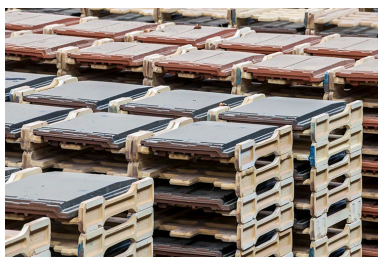
Tuilerie et briqueterie Migeon, à Lantenne-Vertière : unité de fabrication UL 2. Tuiles sur leurs supports réfractaires individuels (destinés au four piscine). Phot. Jérôme Mongreville IVR43_20152501335NUC4A
