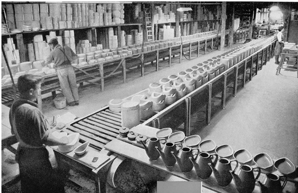
Faïencerie des Capucins, Salins-les-Bains : la chaîne de coulage, [3e quart 20e siècle].
