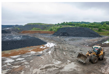
Tuilerie et briqueterie Migeon, à Lantenne-Vertière : la carrière. Chargeuse sur pneus devant le poste de préparation des terres, où la marne noire et l'argile jaune locales
