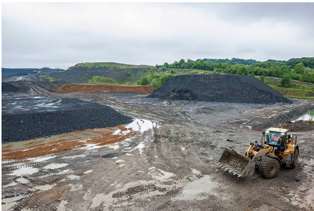
Tuilerie et briqueterie Migeon, à Lantenne-Vertière : la carrière. Chargeuse sur pneus devant le poste de préparation des terres, où la marne noire et l'argile jaune locales sont mélangées avec de l'argile de Gerhardt importée d'Allemagne.
