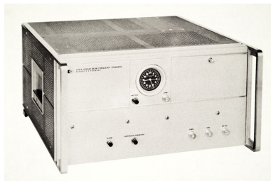
[L'horloge atomique Hewlett-Packard 5061A : vue d'ensemble], 1968. Phot. Jérôme Mongreville IVR43_20112501107NUC4A
