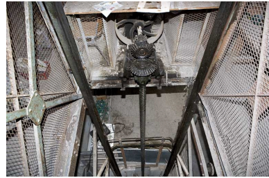
Atelier de préparation de la pâte. Monte-charge. Détail du système à vis. Phot. Yves Sancey IVR43_20092500371NUC2A
