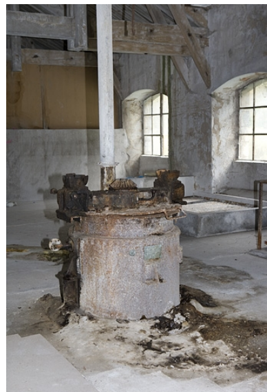
Atelier de préparation de la pâte. Machine pour la préparation de la gélatine (second étage). Phot. Yves Sancey IVR43_20092500370NUC2A
