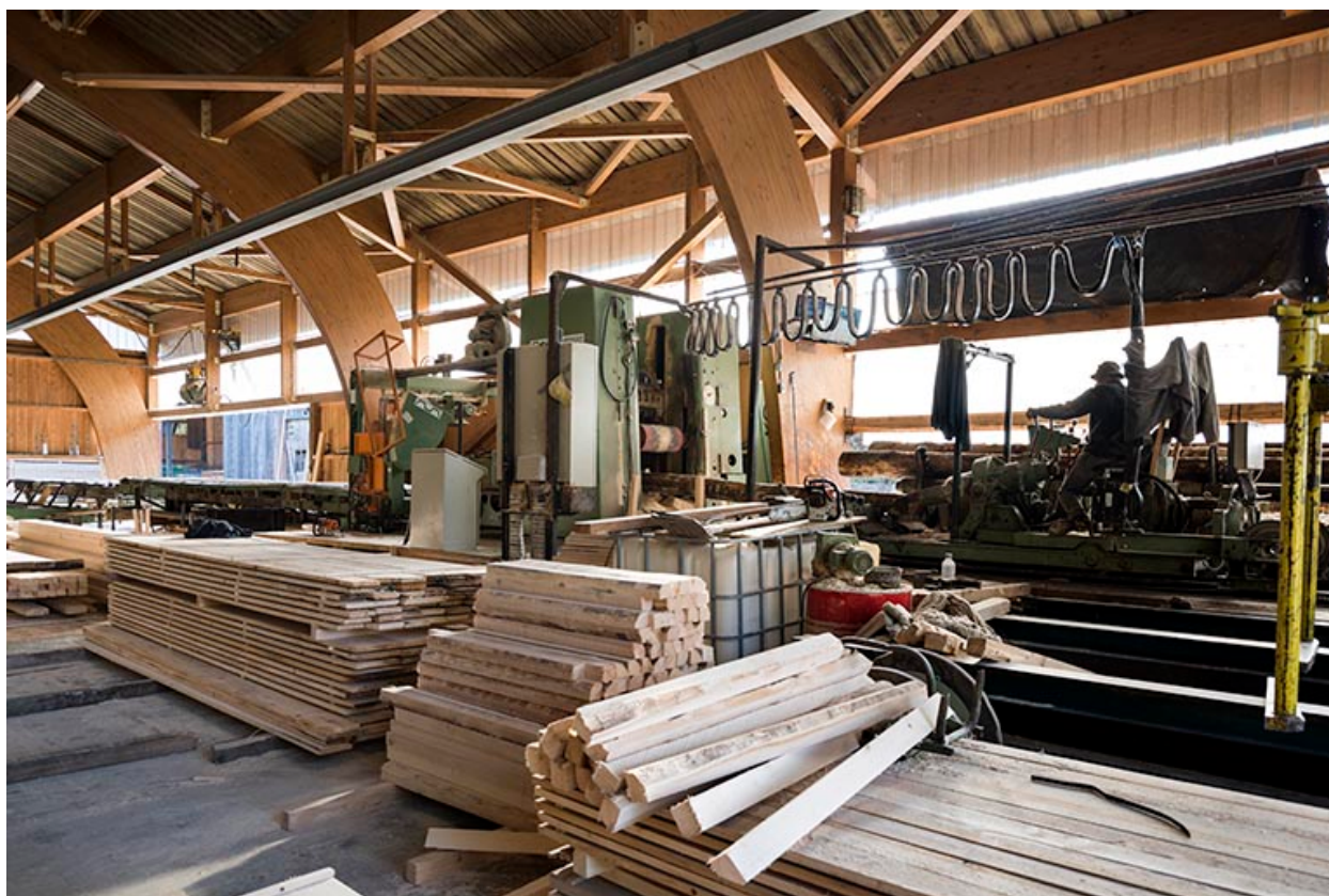
Atelier de fabrication (2000) : châssis multiple Möhringer.
