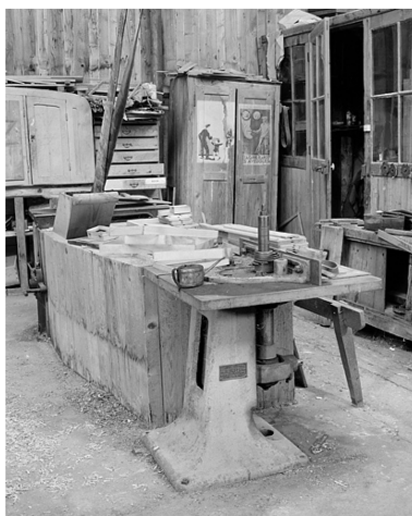
Vue d'ensemble. La caisse en bois dissimule le renvoi de la courroie de transmission. Phot. Yves Sancey IVR43_20022500742X
