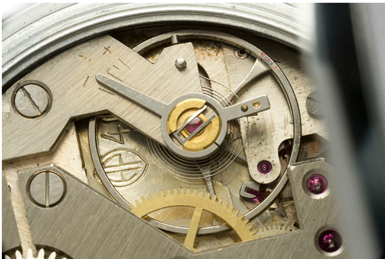
2e montre, mouvement Parrenin HP 40 : logotype et numéro de modèle gravés près du pont de balancier.
