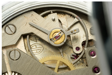
2e montre, mouvement Parrenin HP 40 : logotype et numéro de modèle gravés près du pont de balancier. Phot. Sonia Dourlot IVR43_20162500728NUC4A
