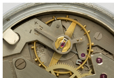
4e montre, mouvement Parrenin HP 40 : numéro de modèle Lip (R 167) gravé près du pont de balancier. Mal effacée, la pointe supérieure du logotype Parrenin est visible à gauche, près d'une vis du balancier.
