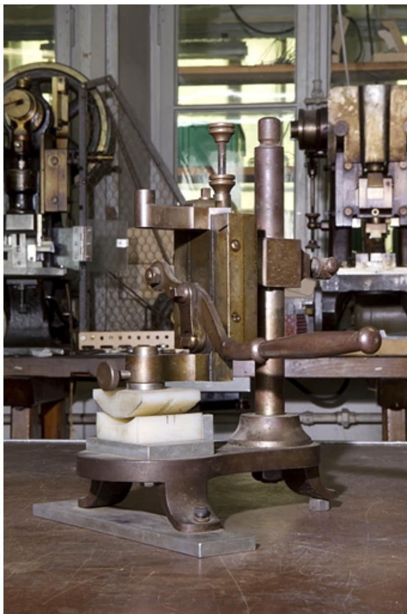
Machine à cintrer les faces, à coulisseau vertical.
