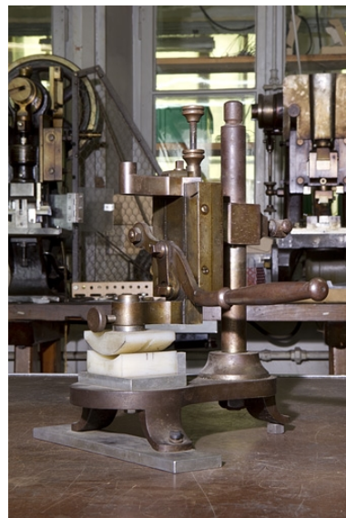
Machine à cintrer les faces, à coulisseau vertical. Phot. Yves Sancey IVR43_20103900287NUC2A
