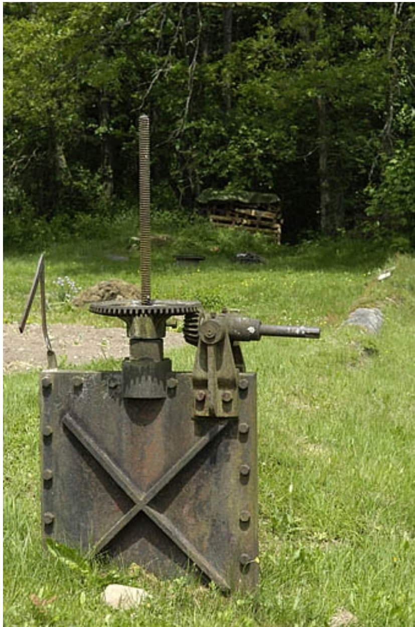
Vannage de la conduite forcée.
