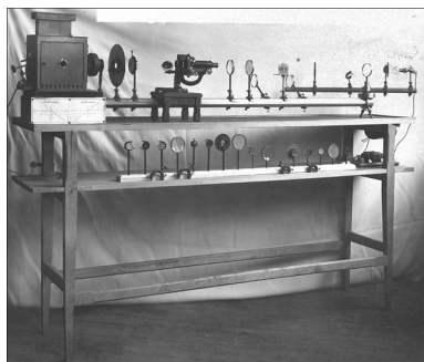
[Appareil de projection et banc d'optique], milieu 20e siècle. Le microscope est utilisé en viseur pour observer des images. Phot. Yves Sancey IVR43_20103900692NUC2A
