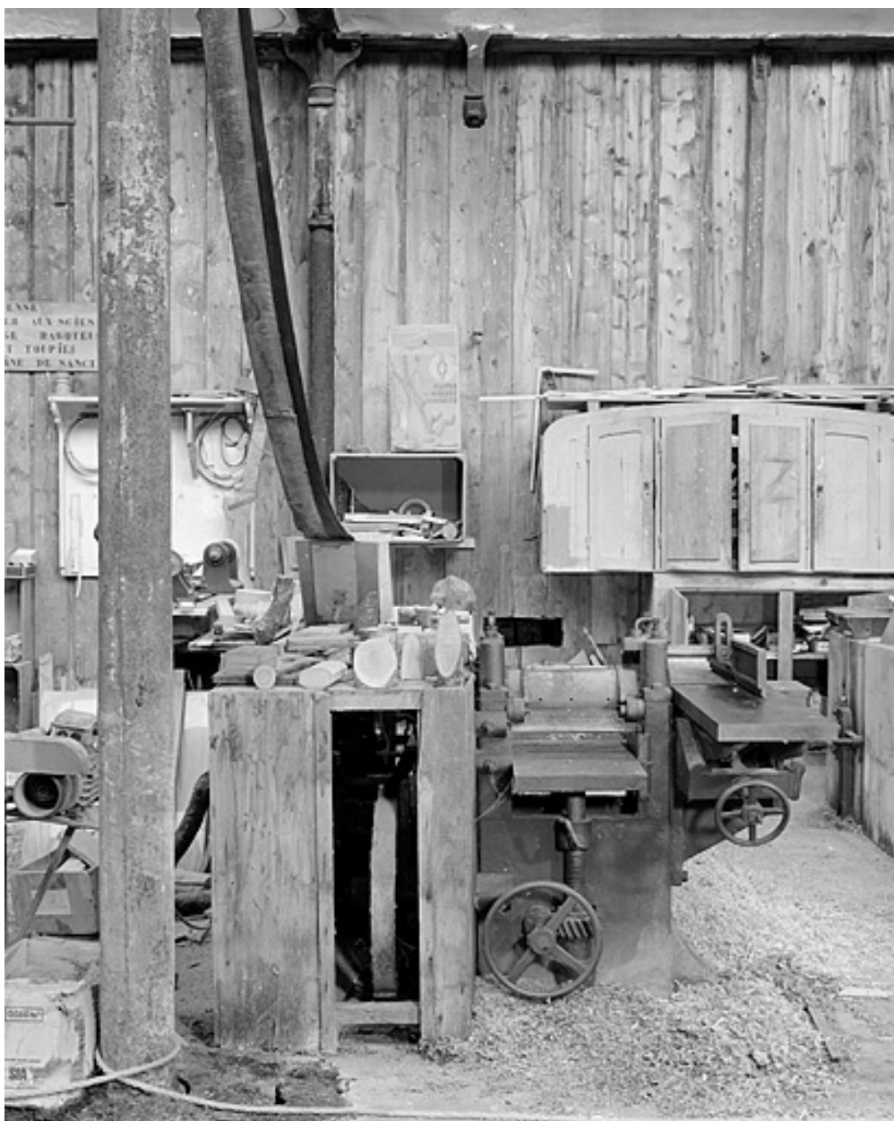
Vue de face, avec la transmission par courroie.
