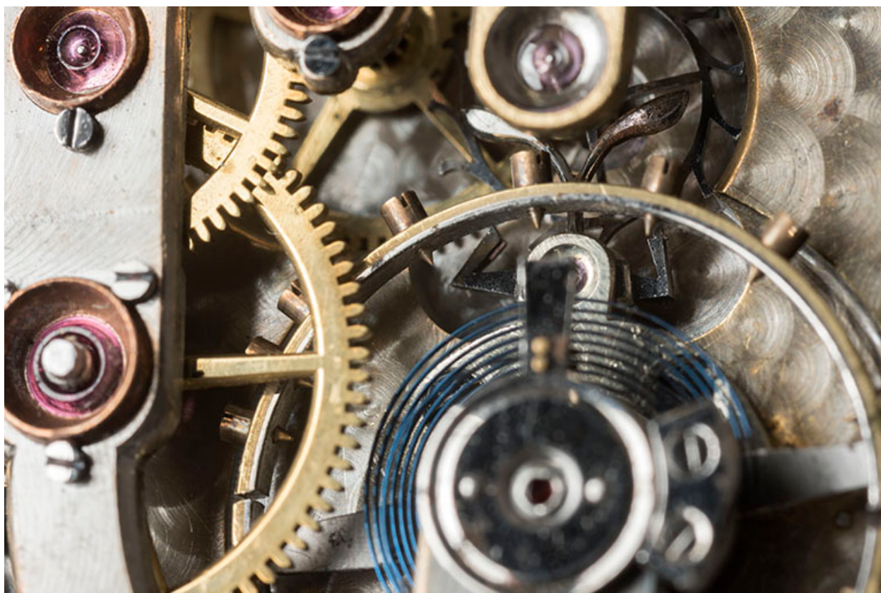
Détail de la roue d'ancre, de l'ancre et de son contrepoids.
