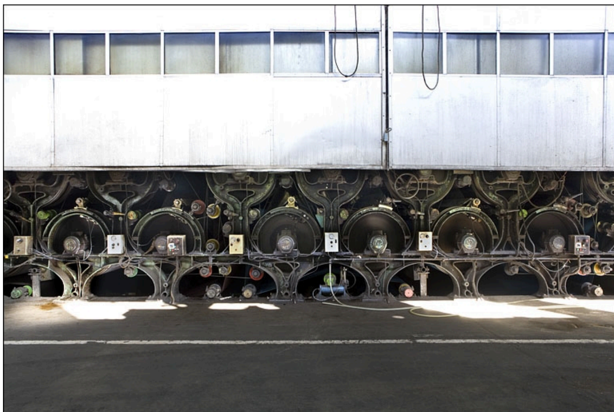
Machine à papier. Le calandrage.
