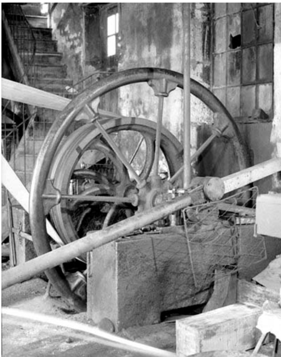
Système d'entraînement : volant d'inertie.
