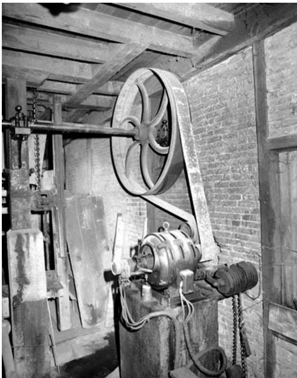
Système d'entraînement : moteur électrique.
