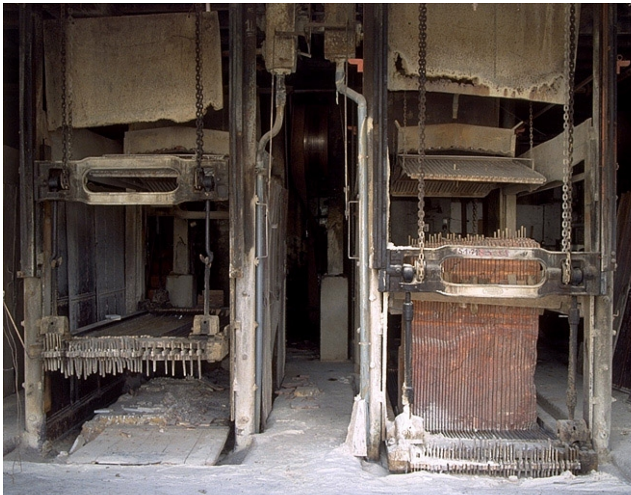
Deux châssis de scie multilames Décamps.
