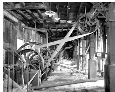
Système d'entraînement : côté transmission. Manivelle et volant d'inertie à droite, bielle au centre. Phot. Yves Sancey IVR43_19933900289X
