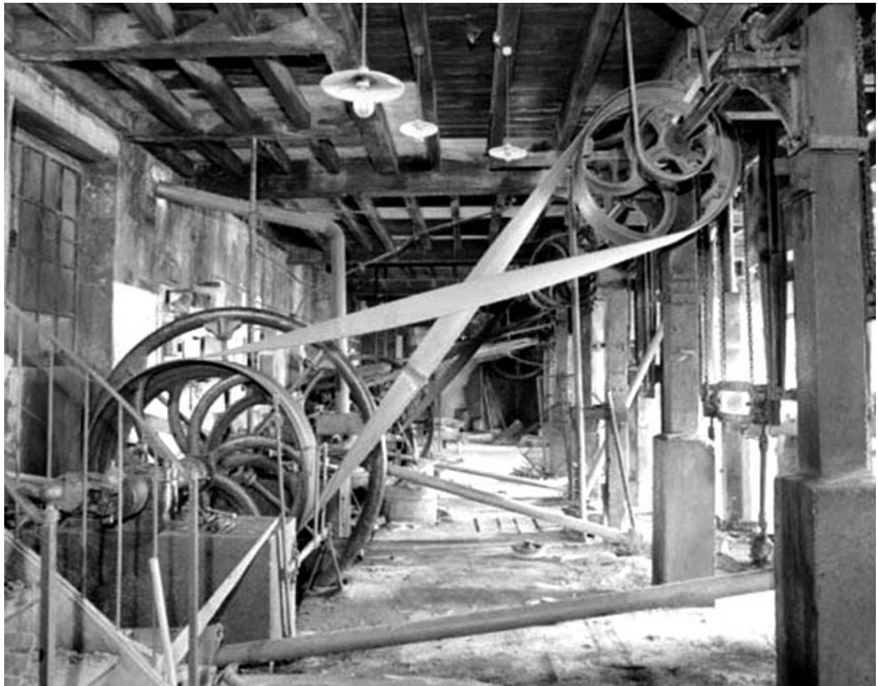
Système d'entraînement : côté transmission. Manivelle et volant d'inertie à droite, bielle au centre.
