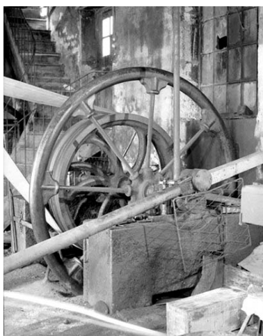
Système d'entraînement : volant d'inertie.
