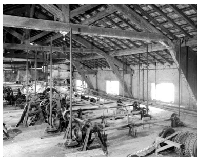
Système de descente à vis (châssis 3 et 4).
