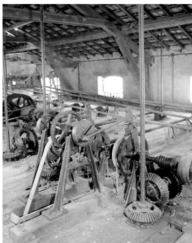
Système de descente à vis : détail.
