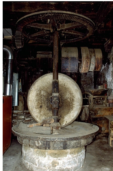
Atelier de fabrication. Au premier plan : meules et transmission. Phot. Jérôme Mongreville IVR43_19953900531ZA
