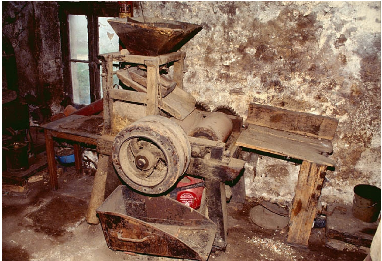
Appareil à cylindres. Cet appareil permet d'écraser les matières oléagineuses.
