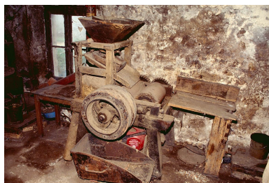
Appareil à cylindres. Cet appareil permet d'écraser les matières oléagineuses. Phot. Jérôme Mongreville IVR43_19953900535ZA
