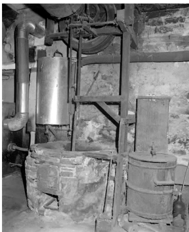
Chaudière. Permet de cuire la mouture sortie des meules. Phot. Jérôme Mongreville IVR43_19953900538X
