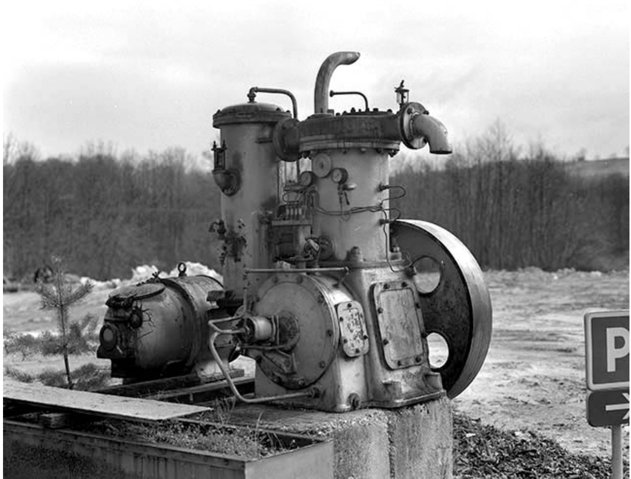
Compresseur (1934, Cie Fives-Lille). Aujourd'hui déposé dans une cour, il aurait été utilisé par la carrière Clément pour l'extraction du gypse.
