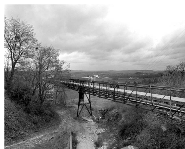
La plâtrière depuis l'atelier de distribution et de concassage de la carrière. Au premier plan : un convoyeur à bandes. Phot. Yves Sancey IVR43_19973900405X
