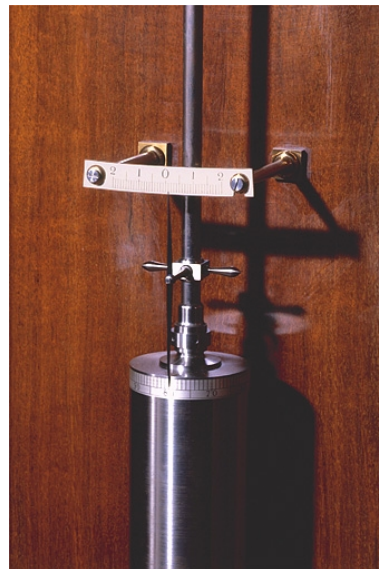
Système de réglage du balancier, de trois quarts. Phot. Yves Sancey IVR43_20032501179XA
