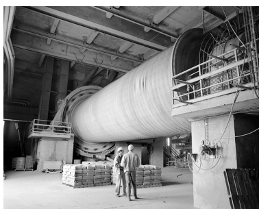
Cimenterie de la S.A. Ciments de Champagnole, Rochefort- sur-Nenon : broyeur de clinkers. Phot. Yves Sancey IVR43_19883900623X
