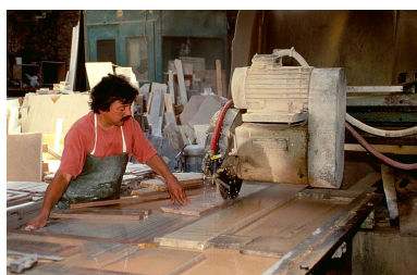
Marbrerie Mourlot puis Yelmini Artaud, Balanod : débitage de plinthes en marbre de Balanod. Phot. Yves Sancey IVR43_19973901736ZA
