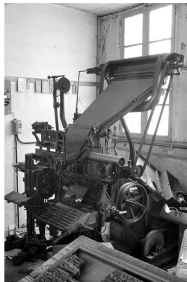
Pièce de séchage, rez-de-chaussée : Linotype. Phot. Laurent Poupard IVR43_19893900110Z
