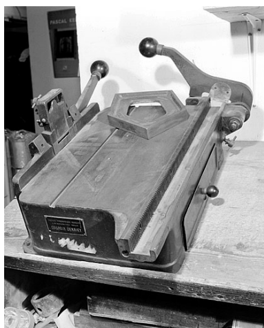
Vue d'ensemble. Guide pentagonal entre le "couteau-rabot" pour les coupes obliques, à gauche, et le "couteau-guillotine" pour les coupes de longueur, à droite. Phot. Jérôme Mongreville IVR43_20013900728X
