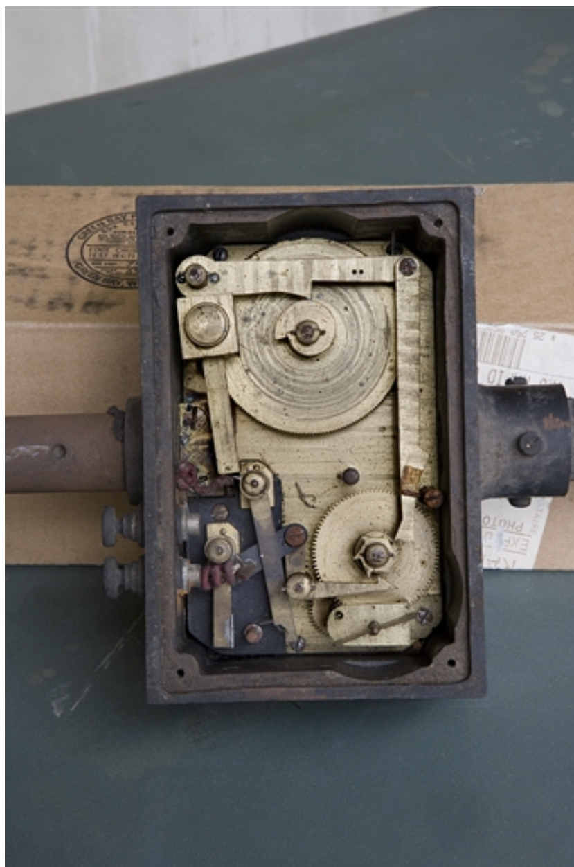
Détail de la partie transmission du capteur.
