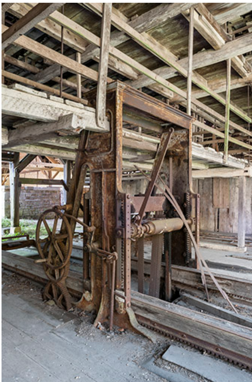
Châssis de scie à lames multiples
