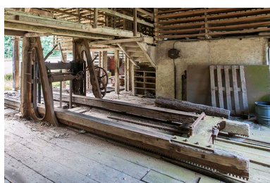
Châssis de scie et son chariot à grumes. Phot. Jérôme Mongreville IVR43_20152501889NUC4A
