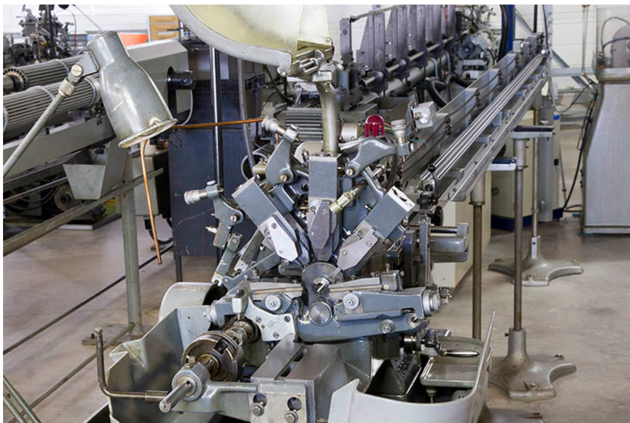
Machine à décolleter Tornos M-7 : usine de décolletage des Ets Perrenoud (rue Pierre Mendès-France).
