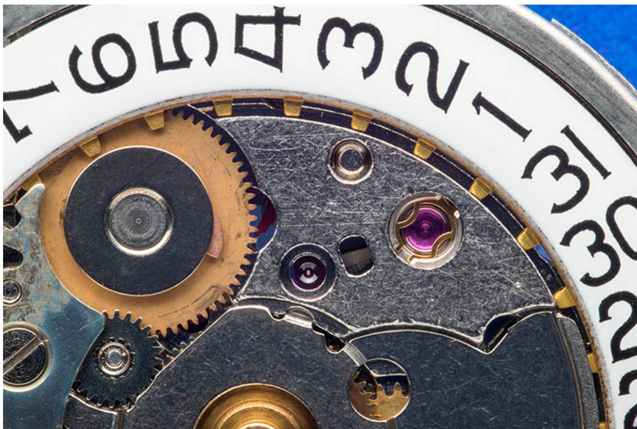
Détail de la face côté cadran : barillet et sa roue dentée à gauche, amortisseur de chocs Incabloc à droite..
