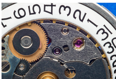
Détail de la face côté cadran : barillet et sa roue dentée à gauche, amortisseur de chocs Incabloc à droite.. Phot. Sonia Dourlot IVR43_20152500236NUC4A
