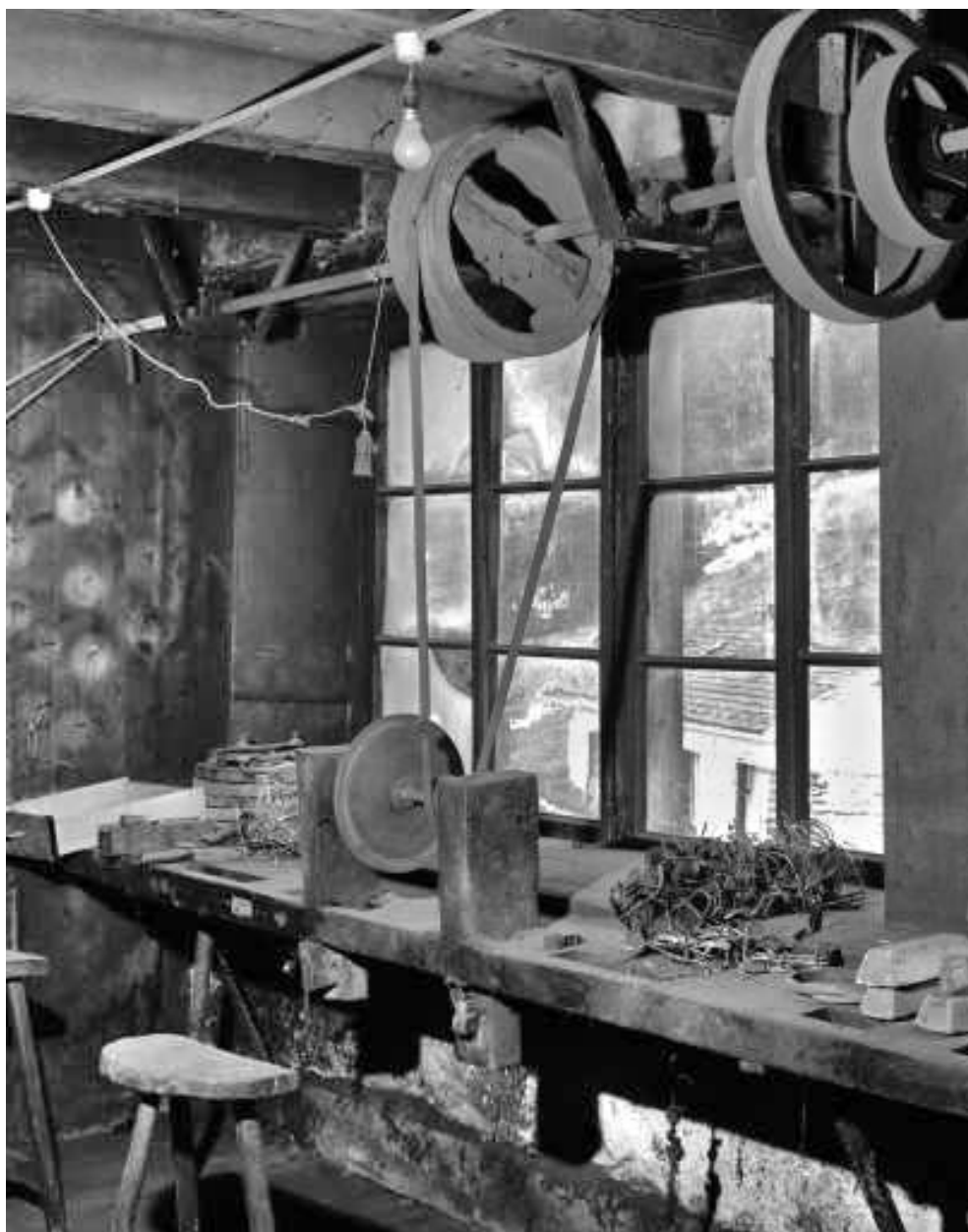
Intérieur : tour à polir et transmission.
