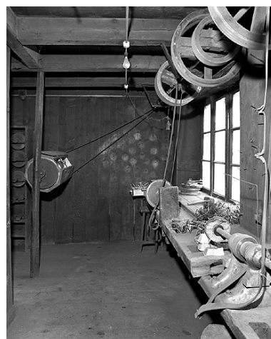
Intérieur : tonneau de polissage et tours à polir. Phot. Yves Sancey IVR43_19903900373X
