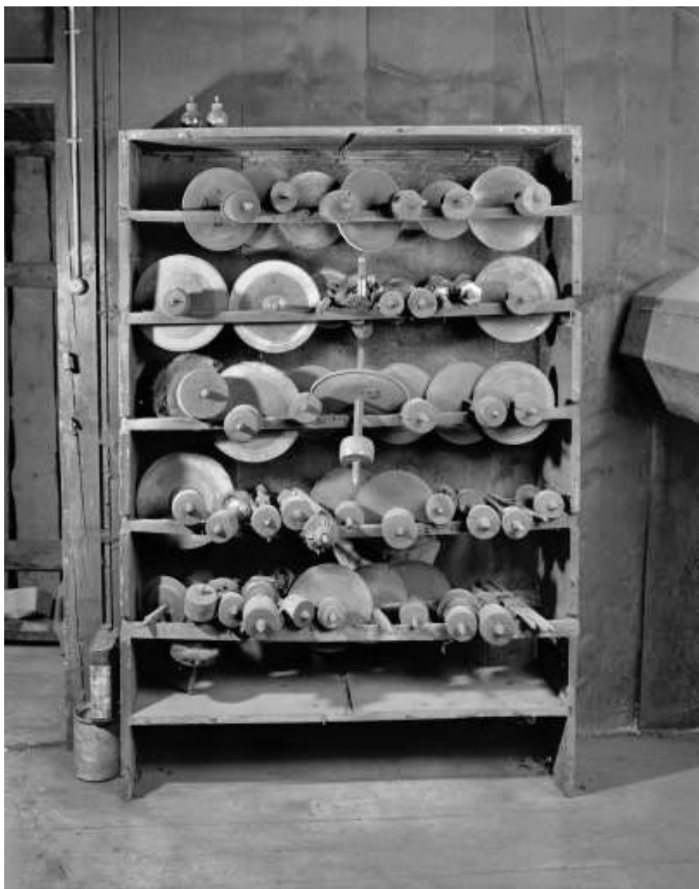
Intérieur : disques à polir.
