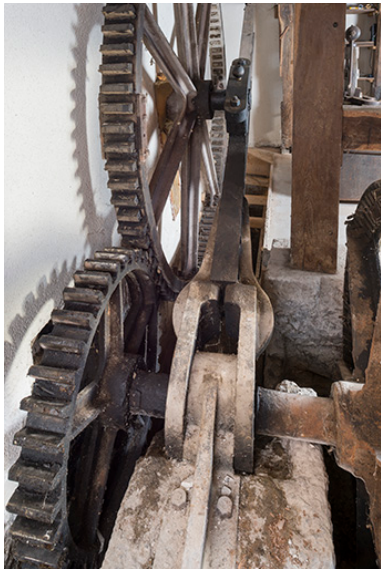
Détail des engrenages du système de levage de la roue suspendue (aval). Phot. Jérôme Mongreville IVR43_20162501618NUC4A
