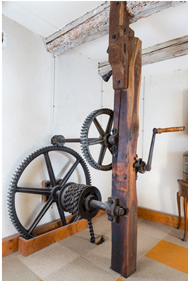
Premier étage. Système de levage (par manivelle et chaîne) de la roue suspendue (aval). Phot. Jérôme Mongreville IVR43_20162501621NUC4A
