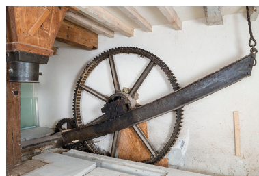
Système de levage de la roue suspendue (amont) : volant engrené (axe de la roue) et levier. Phot. Jérôme Mongreville IVR43_20162501614NUC4A
