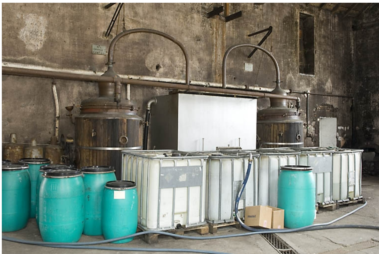
Ancien atelier de distillation. Alambics Egrot-Grangé de 10 hl (mur ouest).
