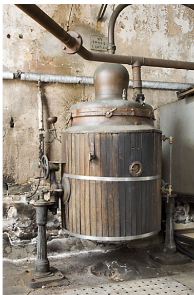
Ancien atelier de distillation. Détail d'un alambic Egrot-Grangé. Phot. Jérôme Mongreville IVR43_20077000113NUCA
