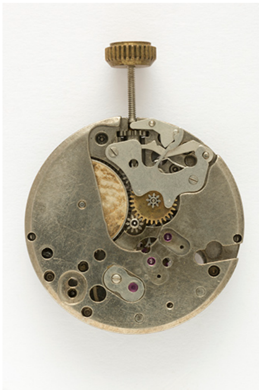
Mouvement Parrenin HP 90 : face côté cadran.
