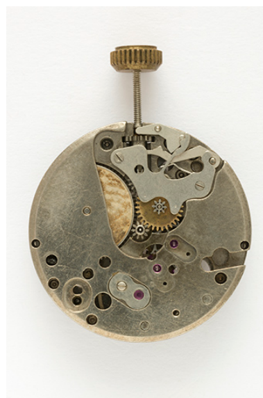
Mouvement Parrenin HP 90 : face côté cadran. Phot. Sonia Dourlot IVR43_20162500735NUC4A
