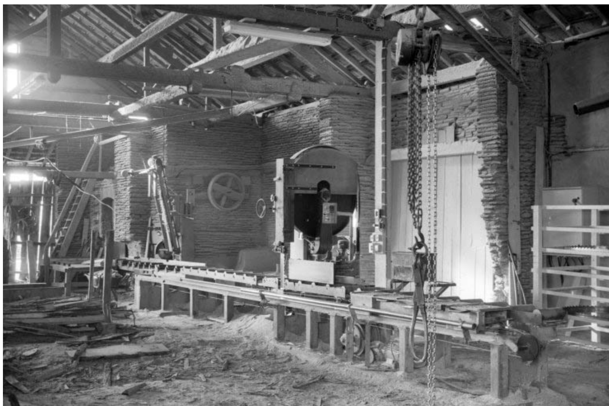
Intérieur de l'atelier de fabrication : scie Marcol.
