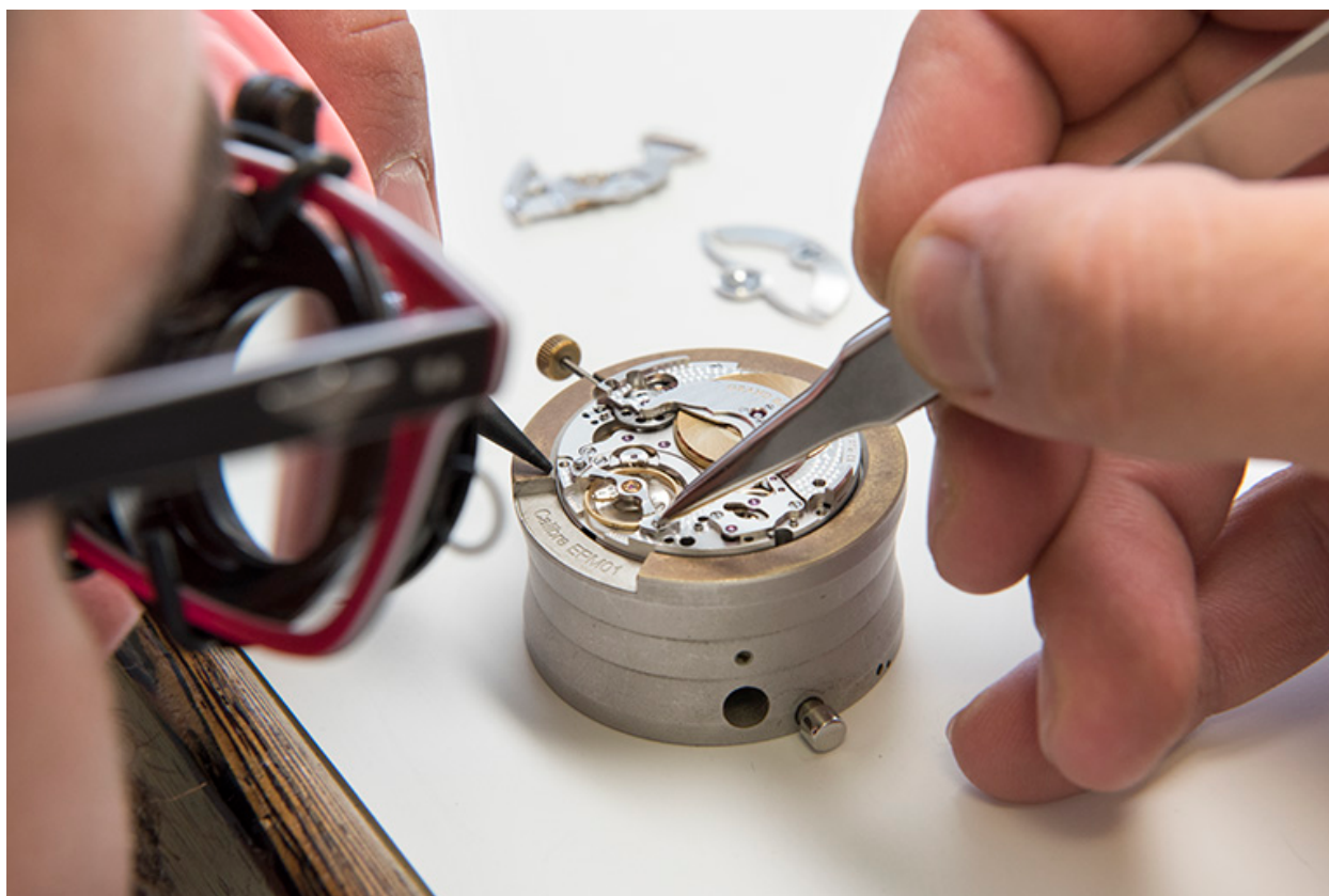
Horloger à l'établi : montage d'un Calibre Royal.
