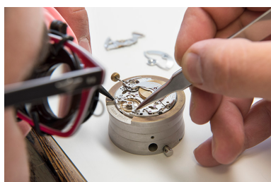
Horloger à l'établi : montage d'un Calibre Royal. Phot. Sonia Dourlot IVR43_20182501117NUC4A
