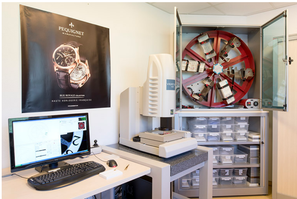
Laboratoire : machine de contrôle optique Micro.Vu (Vertex 120) et simulateur de mouvements VOH (Twistest).
