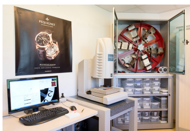
Laboratoire : machine de contrôle optique Micro.Vu (Vertex 120) et simulateur de mouvements VOH (Twistest). Phot. Sonia Dourlot IVR43_20182501121NUC4A
