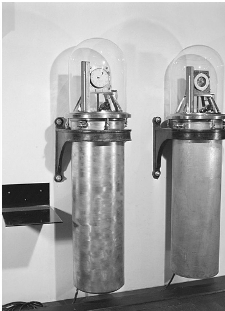
Vue d'ensemble des horloges à pression constante Leroy exposées au Musée du Temps. A gauche horloge n° 1450, à droite horloge n° 1723.
