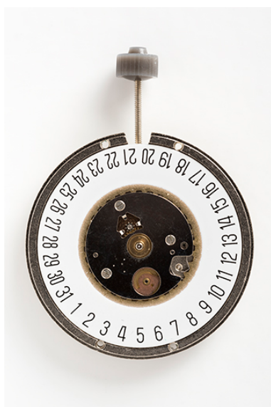
Mouvement France Ebauches FE 7221 : face côté cadran. Phot. Sonia Dourlot IVR43_20172500204NUC4A
