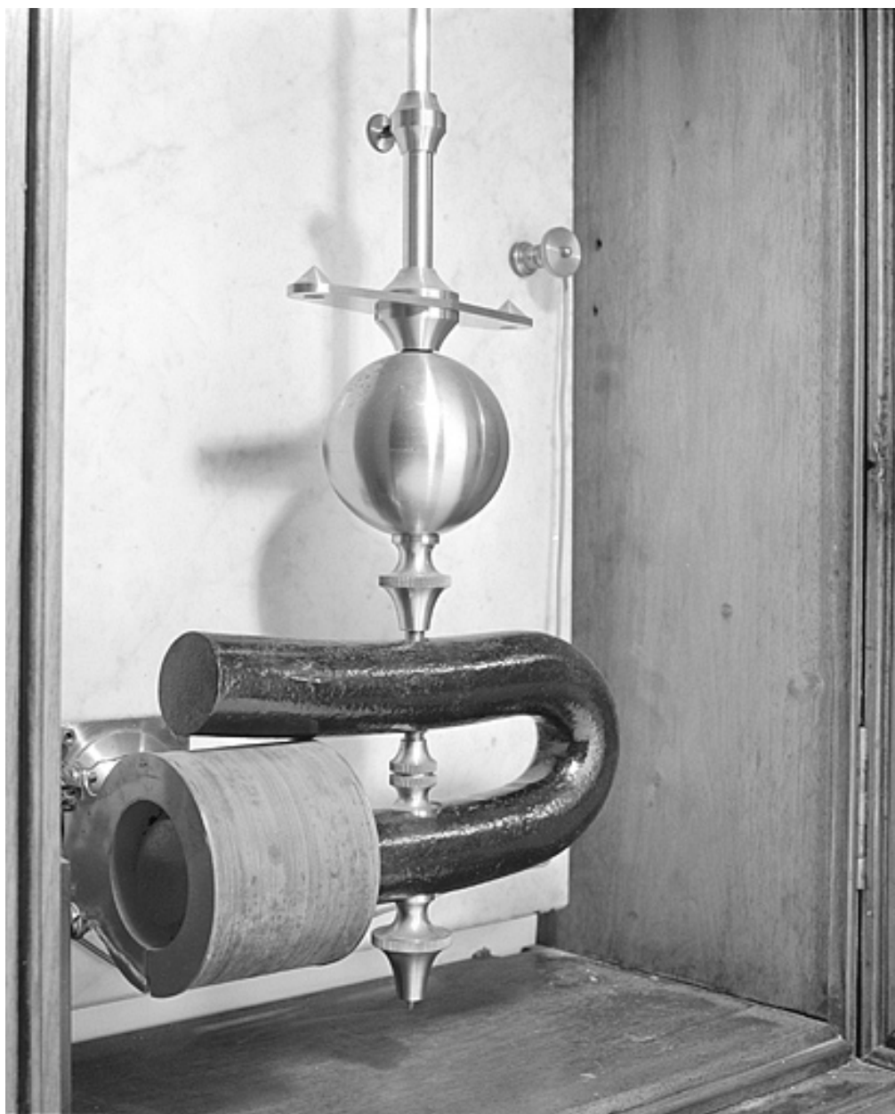
Le balancier (avec masse circulaire et aimant).
