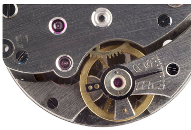
1er mouvement, détail côté ponts : balancier-spiral et mécanisme de réglage de la marche diurne. La roue de cylindre se devine à l'arrière-plan.
