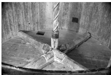
Intérieur : étage, salle de la bluterie, pales du mélangeur à farines. Phot. Laurent Poupard IVR43_19883900014Z
