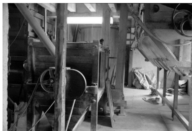
Intérieur : étage, salle de la bluterie. A droite extracteur à 6 pans, à gauche bluterie centrifuge, en arrière-plan mélangeur à farines. Phot. Laurent Poupard IVR43_19883900011Z
