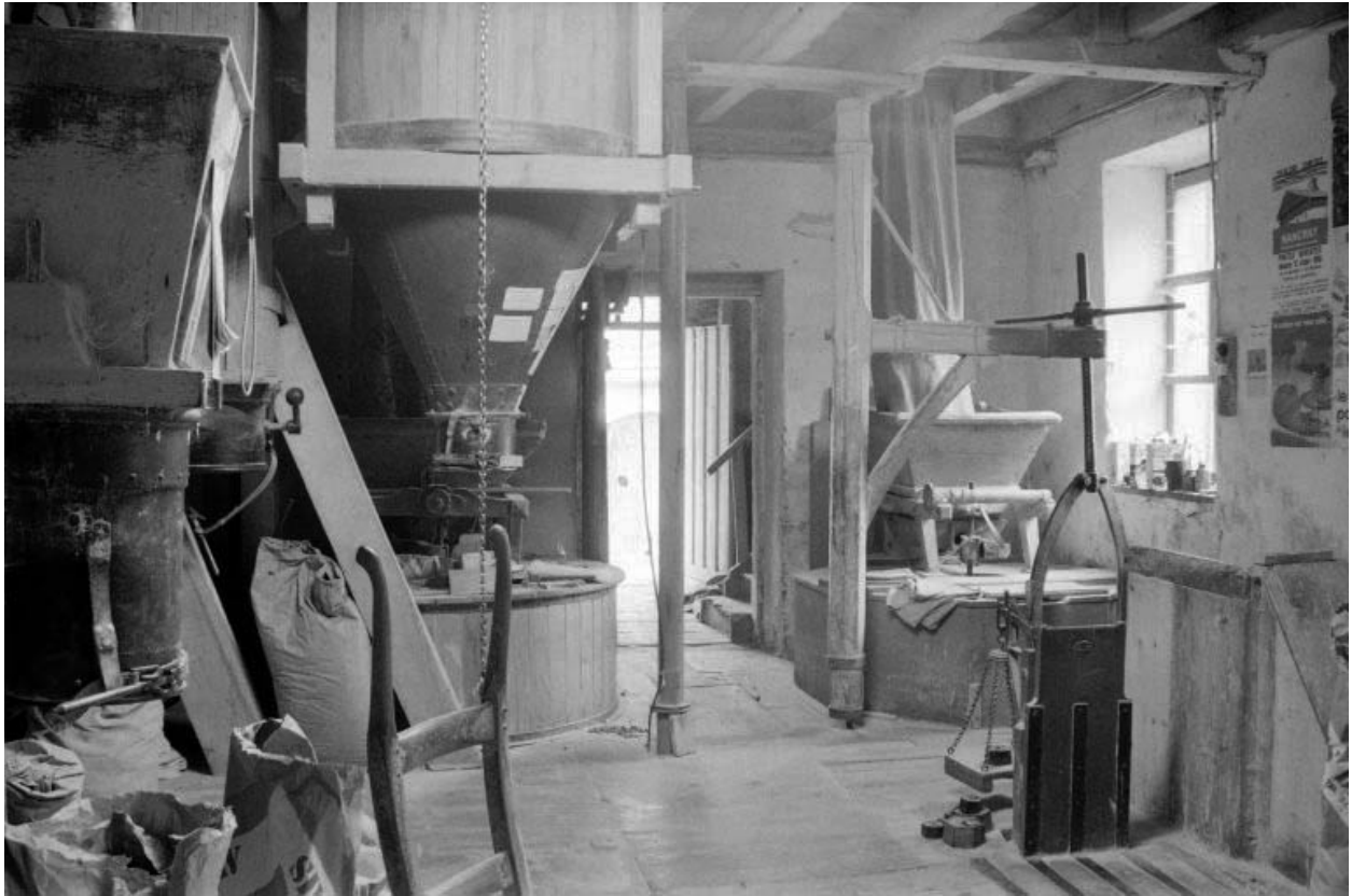
Intérieur : rez-de-chaussée, salle des meules. Trémie à farine à gauche et potence à droite, en avant des deux paires de meules.
