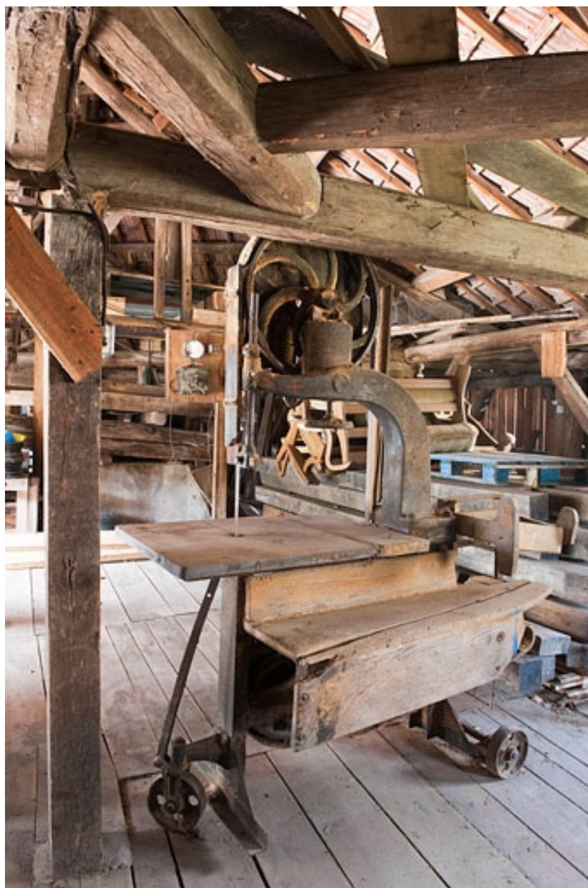
Scierie Courtot, rue du Pont : scie à ruban.
