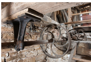
Scierie Courtot, rue du Pont : arbre de transmission. Phot. Jérôme Mongreville IVR43_20102500412NUC4A
