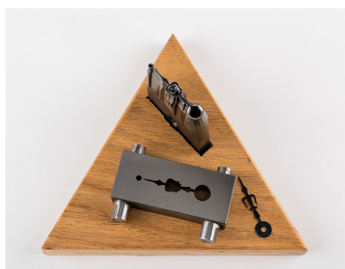
Outils pour découper les aiguilles (collection musée de l'Horlogerie, Morteau).
