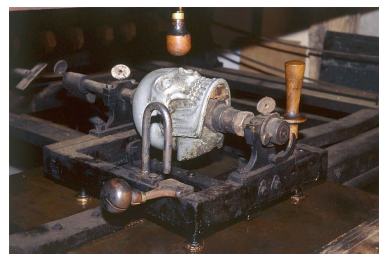
Support du modèle. Bougée à l'aide d'une poignée verticale et d'une poignée horizontale, cette partie du bâti mobile glisse sur une plaque métallique. Noter au-
