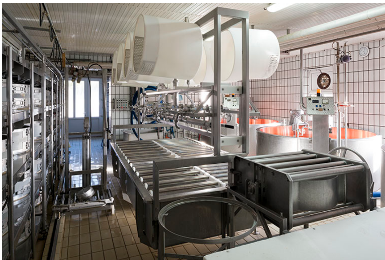
Atelier de fabrication : vue d'ensemble avec le répartiteur du groupe de soutirage par pompe à caillé.
