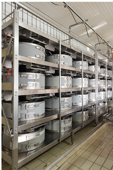
Atelier de fabrication : installation de pressage pneumatique.
