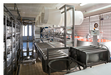
Atelier de fabrication : vue d'ensemble avec le répartiteur du groupe de soutirage par pompe à caillé. Phot. Sonia Dourlot IVR43_20172501816NUC4A
