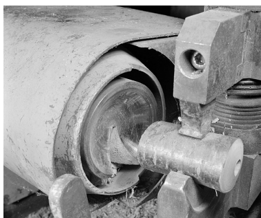
Détail de l'outil de coupe côté gauche. Phot. Jérôme Mongreville IVR43_20022500570X
