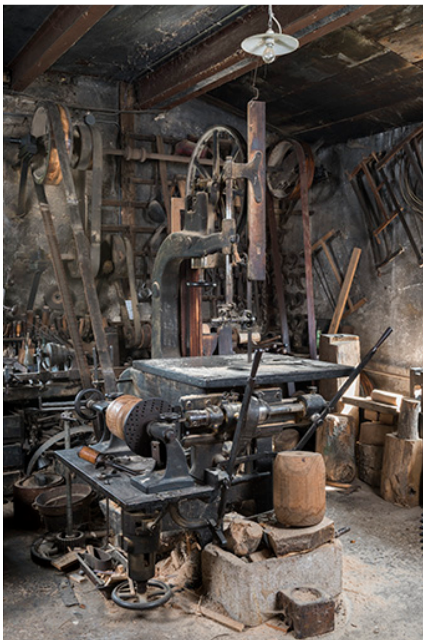
Forge : scie à ruban et mortaiseuse Mougeotte (Melay, Haute-Marne).
