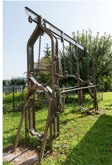
Travail à ferrer métallique. Phot. Sonia Dourlot IVR43_20172501200NUC4A
