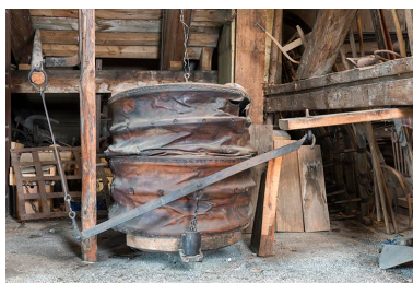
Soufflet en cuir : poids permettant la descente du fond. Phot. Sonia Dourlot IVR43_20172500840NUC4A
