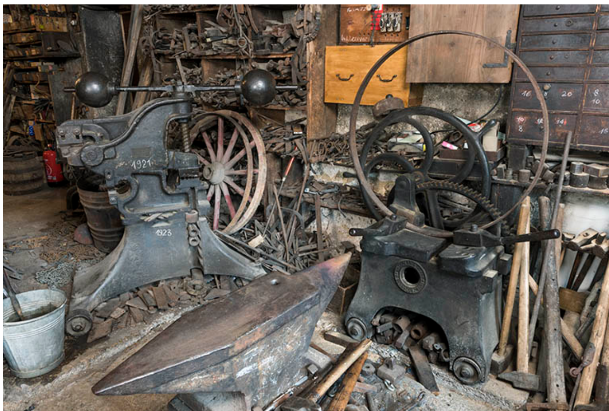
Forge : enclume, cisaille à balancier A. Vernet (Dijon) et refouleuse Jules Gersperrin (Besançon).
