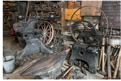
Forge : enclume, cisaille à balancier A. Vernet (Dijon) et refouleuse Jules Gersperrin (Besançon). Phot. Sonia Dourlot IVR43_20172500849NUC4A
