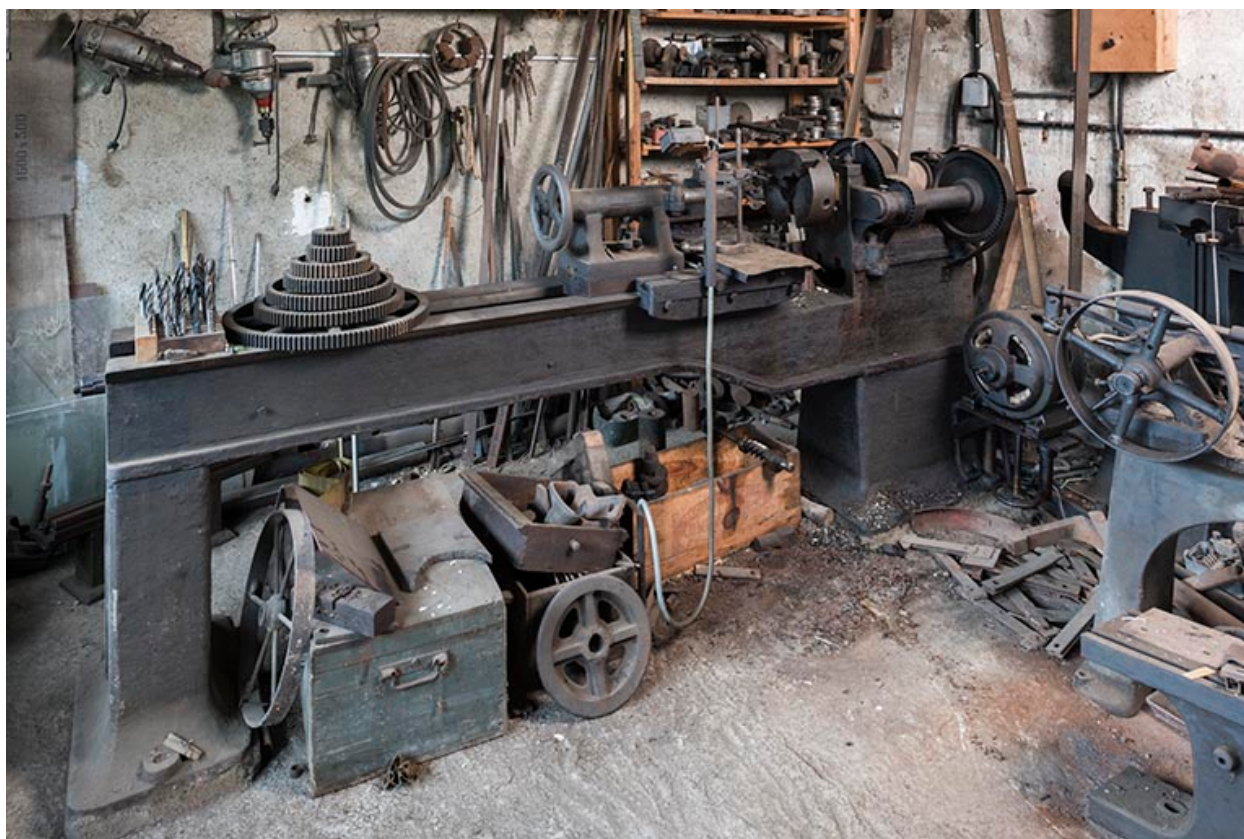
Atelier de mécanique : gros tour de mécanicien.
