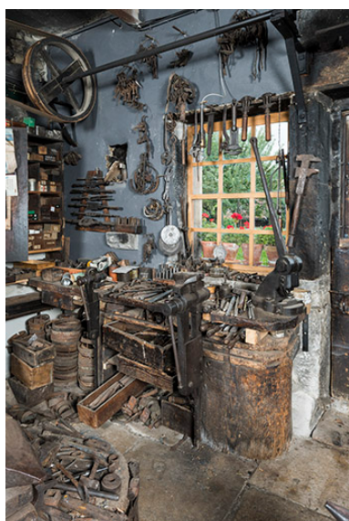
Forge : établi derrière la fenêtre, étaux et transmission. Phot. Sonia Dourlot IVR43_20172500844NUC4A
