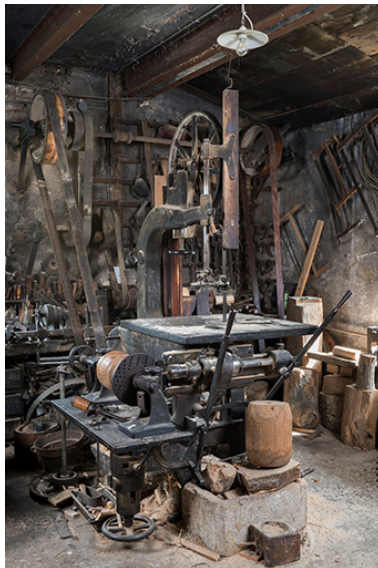
Forge : scie à ruban et mortaiseuse Mougeotte (Melay, Haute-Marne). Phot. Sonia Dourlot IVR43_20172500850NUC4A
