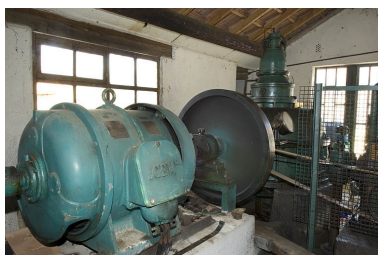
Intérieur de la salle des machines (sud). Alternateur CEM. Phot. Jérôme Mongreville IVR43_20067000303NUCA
