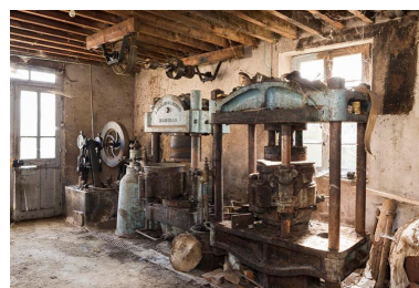
Vue des machines du rez-de-chaussée: pompe hydraulique, régulateur et deux presses hydrauliques Phot. Sonia Dourlot IVR43_20167001307NUC4A
