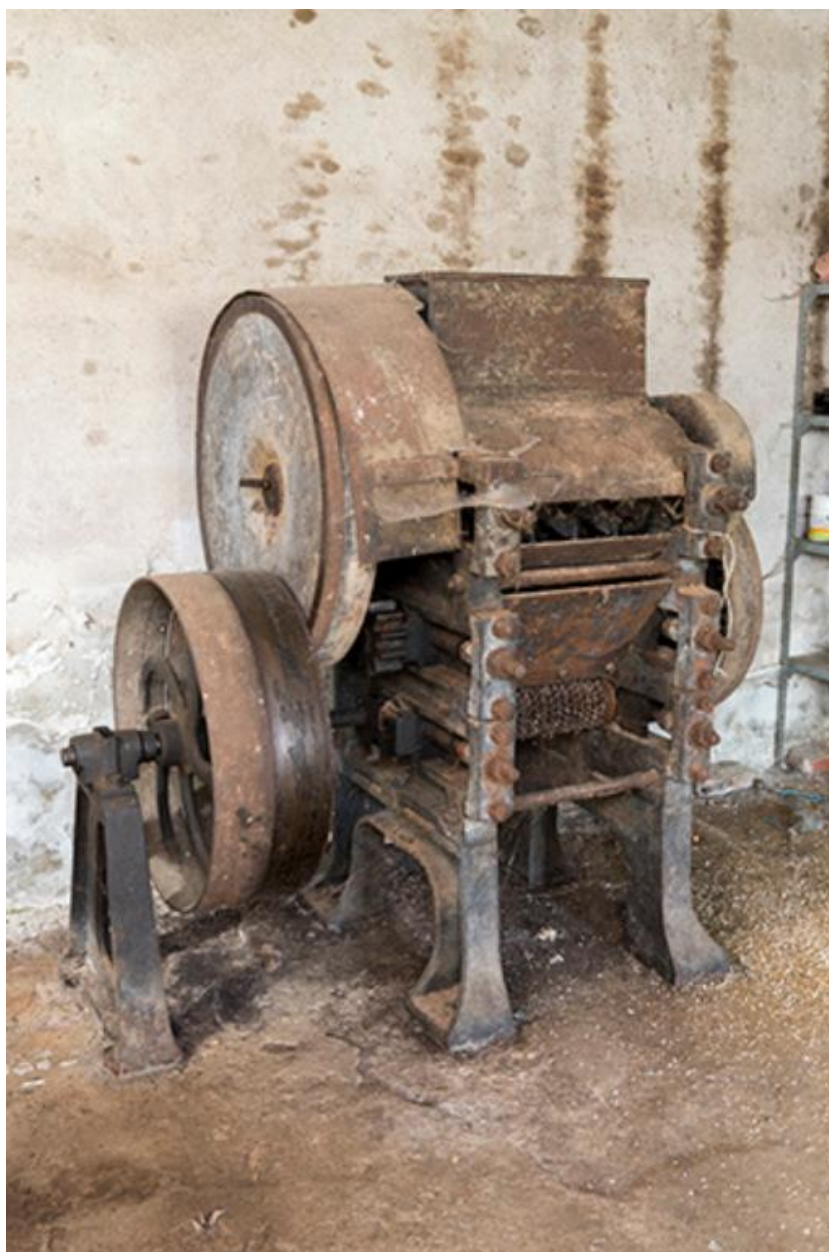
Machine du rez-de-chaussée: broyeur à tourteaux
