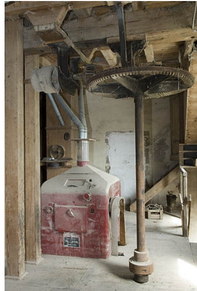
Convertisseur Ph. Lafon et arbre de transmission (1er étage). Phot. Jérôme Mongreville IVR43_20067000335NUCA
