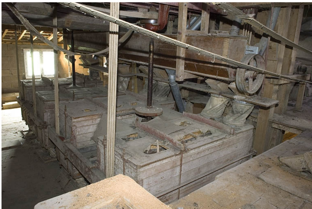
Vue plongeante sur les plansichters (3e étage).
