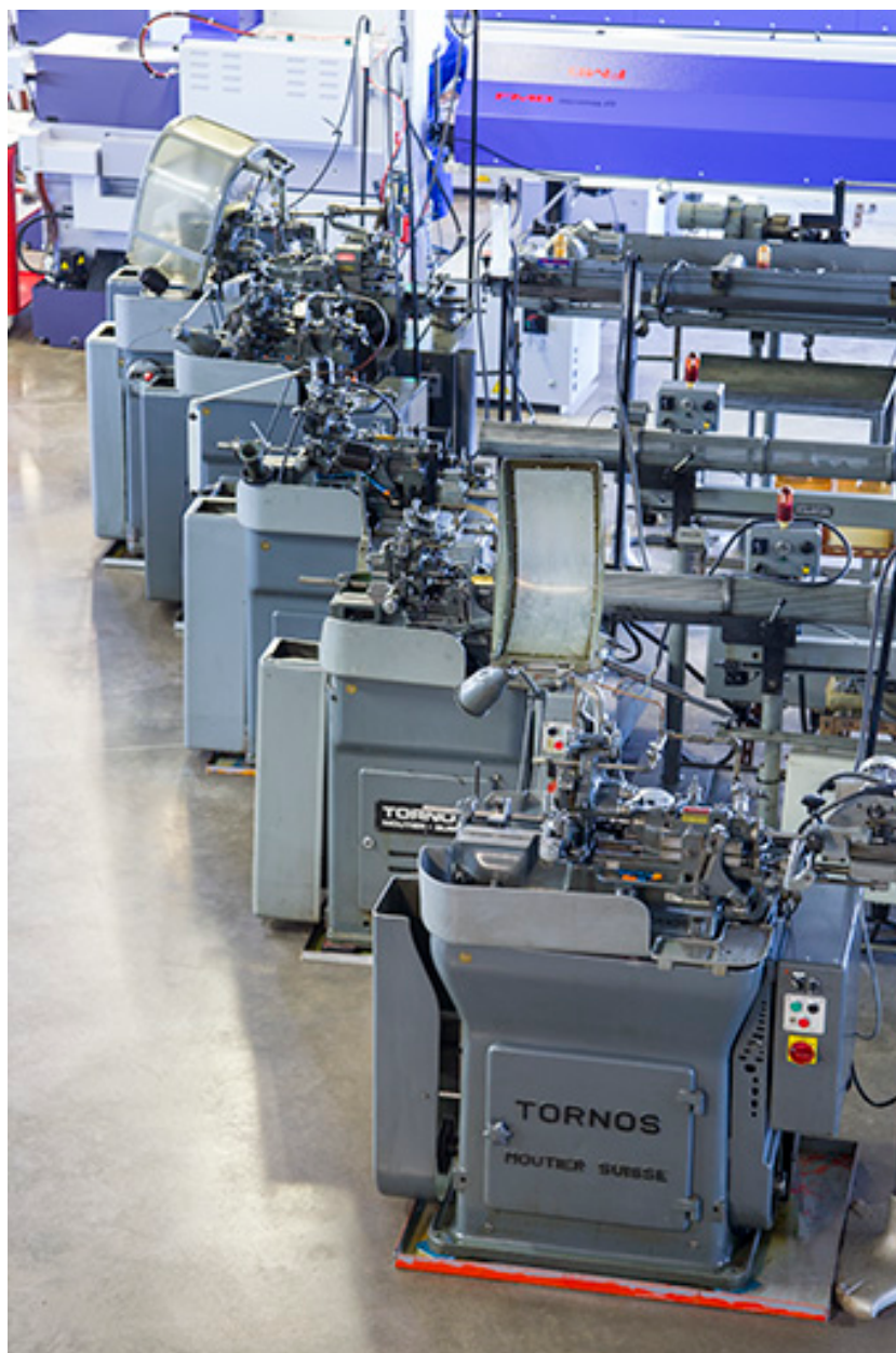
Machines à décolleter Tornos : détail des machines.
