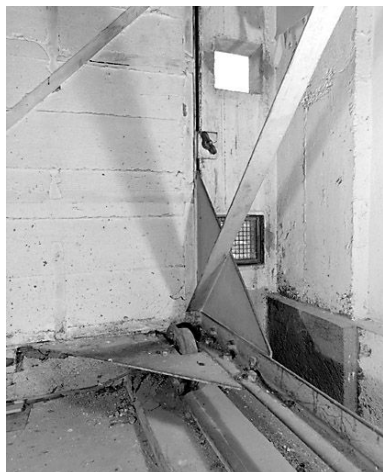
Roue et chemin de roulement du chariot mobile portant le cadran extérieur. Phot. Jérôme Mongreville IVR43_20023900410X
