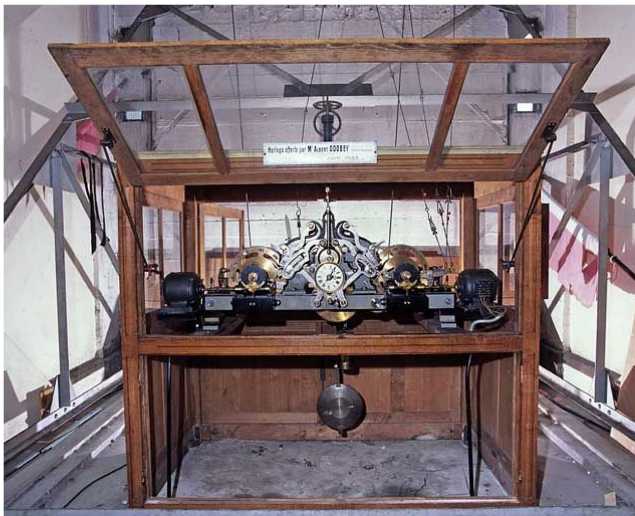
Le mouvement dans sa caisse en chêne.
