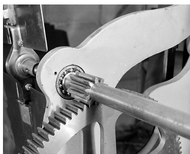
Axe sur roulement à billes. Phot. Jérôme Mongreville IVR43_20023900412X
